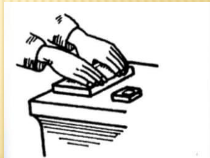
Фиг. 2.112. Подготовка а повърхнина за шаброване
